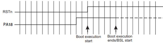
그림 10-1. 구성된 GPIO 핀에서의 BSL 입력 시퀀스
