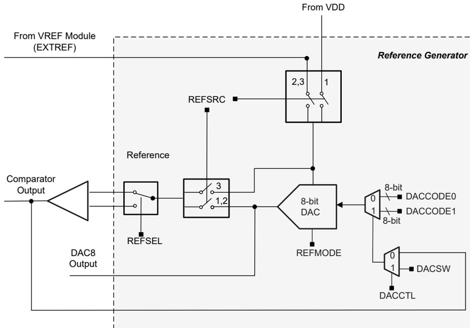
그림 6-4. 8비트 DAC 블록 다이어그램
