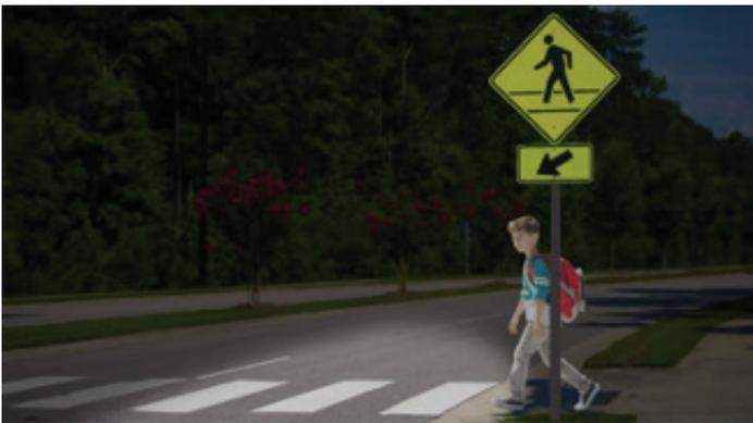
**Abbildung 7.** DLP-Scheinwerfer beleuchtet ein Kind beim Überqueren der Straße und dimmt gleichzeitig das Licht, welches das Zebrastreifen-Schild beleuchtet, um Blendeffekte zu reduzieren.
