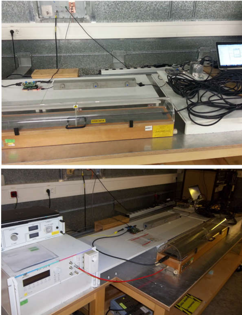
Abbildung 7-39. EFT-Testkonfiguration nach IEC 61000-4-4 für TIDA-00176 (rechte Seite oben, linke Seite unten)
