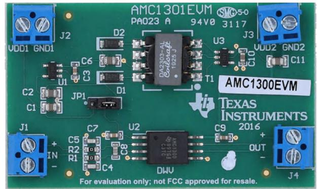
**Abbildung 1.** Das AMC1300 EVM mit einem isolierten Transformator.
