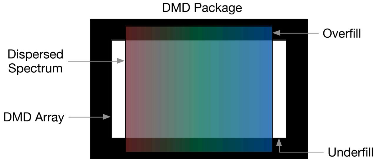
**Figure 3. Typical DMD Underfill / Overfill Pattern**
