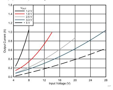
Figure 26. Pulse-Skipping Threshold
