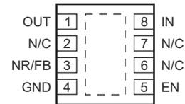
Figure 4-2. DRB Package, 8-Pin VSON (Top View)
