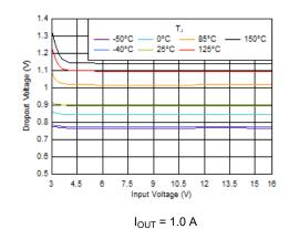
Figure 5-11. V<sub>DO</sub> vs V<sub>IN</sub>
