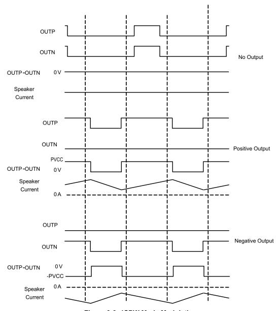
Figure 9-9. 1SPW Mode Modulation
