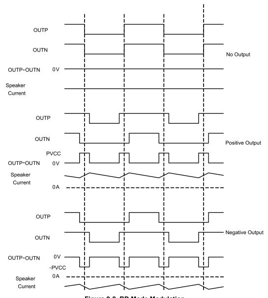
Figure 9-8. BD Mode Modulation
