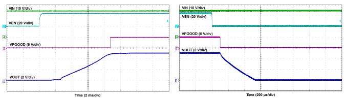
Figure 29. Enable Turn-ON
