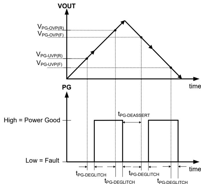
**Figure 7-6. Power-Good Thresholds**
