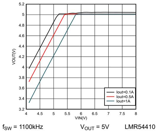
**Figure 6-9. 5V Dropout**
