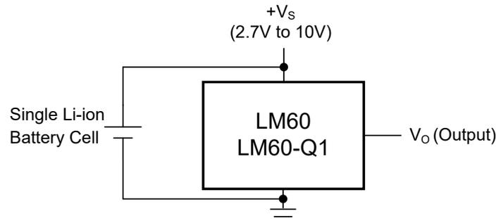
$$V_O = (6.25\text{mV}/^\circ\text{C} \times T^\circ\text{C}) + 424\text{mV}$$
