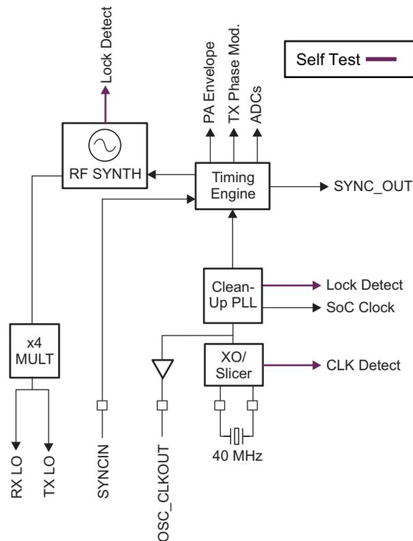
**Figure 6-1. Clock Subsystem**
