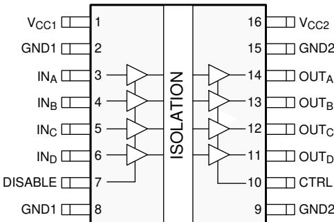
Figure 4-1. ISO7240CF-Q1 DW Package 16-Pin SOIC Top View
