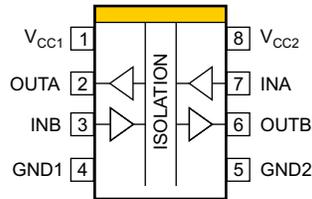
**Figure 4-2. ISO7221x-Q1 D Package 8-Pin SOIC Top View**
