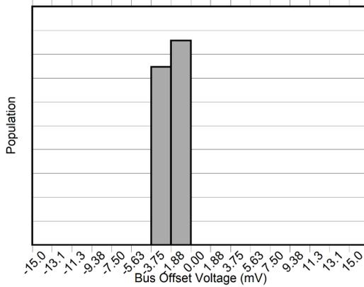
Figure 6-10. Bus Offset Voltage ( $V_{IN-}$ ) Production Distribution
