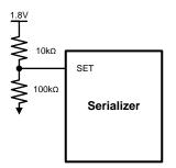
Figure 15. SET Pin configuration on DS90UA101-Q1
