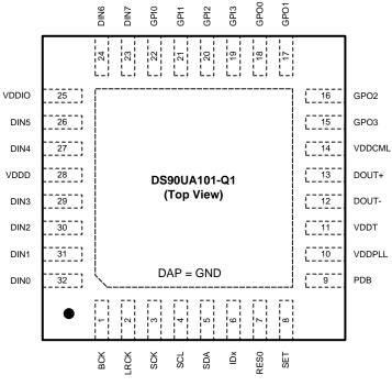
Figure 3. DS90UA101-Q1 — Top View
