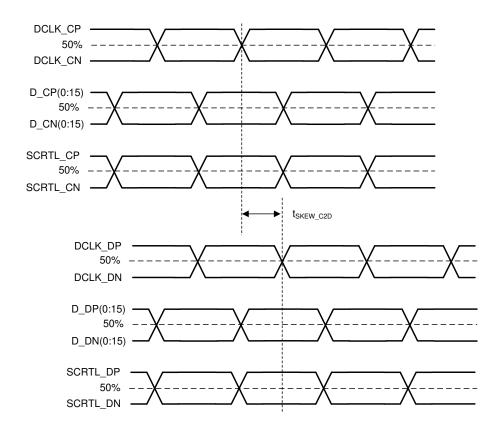
Figure 5-8. LVDS Skew Parameters
