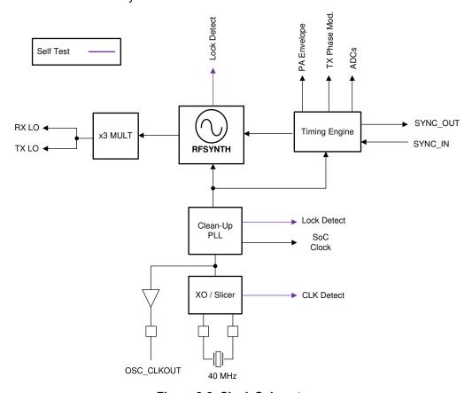
Figure 8-2. Clock Subsystem
