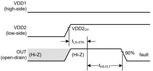
Figure 6-5. VDD2 Turns On, VDD1 Stays Off
