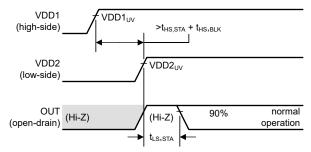
Figure 6-9. VDD1 Turns On, Followed by VDD2 (Long Delay)
