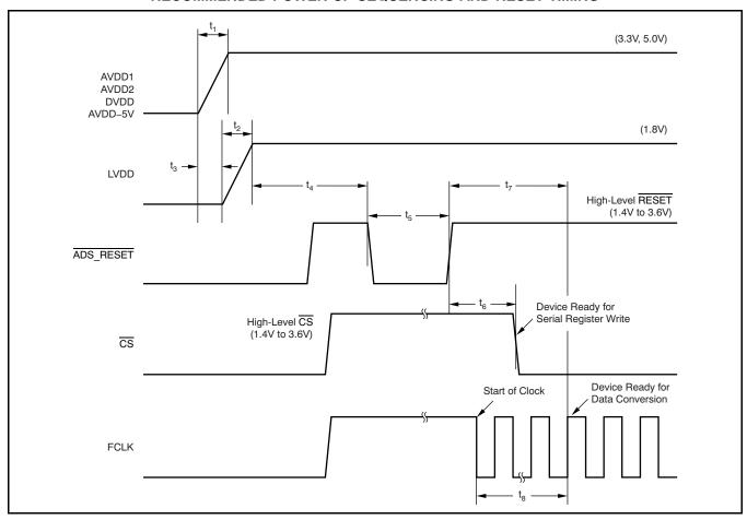
$10\mu s < t_1 < 50ms$ ,  $10\mu s < t_2 < 50ms$ ,  $-10ms < t_3 < 10ms$ ,  $t_4 > 10ms$ ,  $t_5 > 100ns$ ,  $t_6 > 100ns$ ,  $t_7 > 10ms$ , and  $t_8 > 100\mu s$ .
