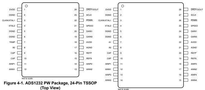
Figure 4-2. ADS1234 PW Package, 28-Pin TSSOP (Top View)
