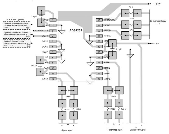
Figure 8-4. ADS1232 Layout Example
