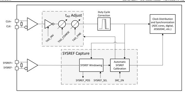
Figure 6-2. Clocking Subsystem
