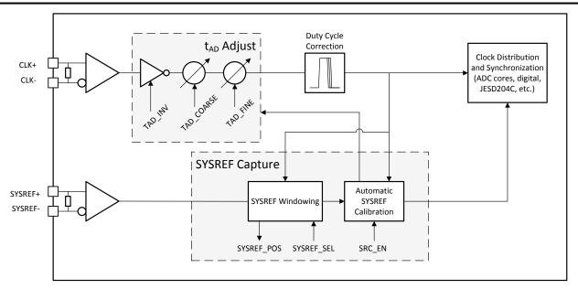
Figure 6-2. Clocking Subsystem
