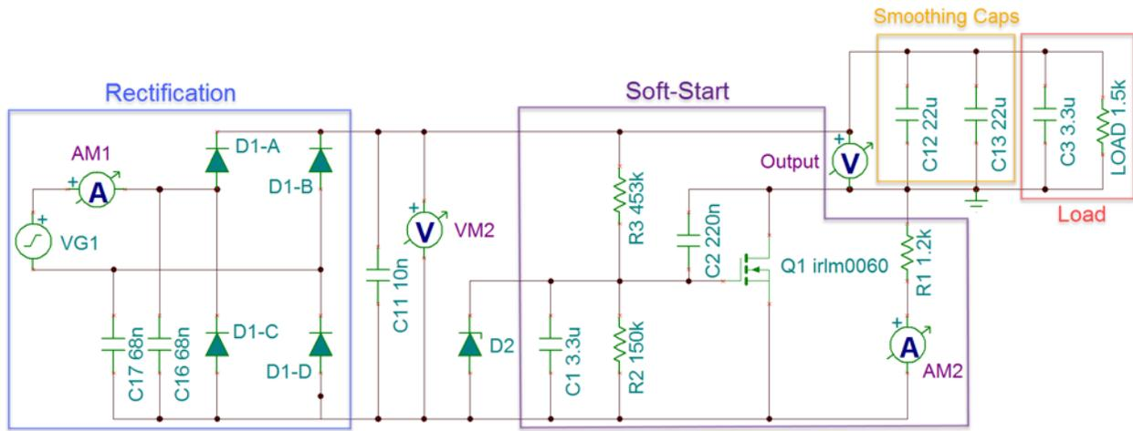
Figure 3. Soft-Start Schematic
