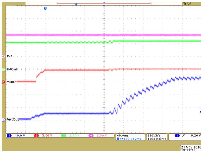
Figure 17. 24- $V_{AC}$  Startup
