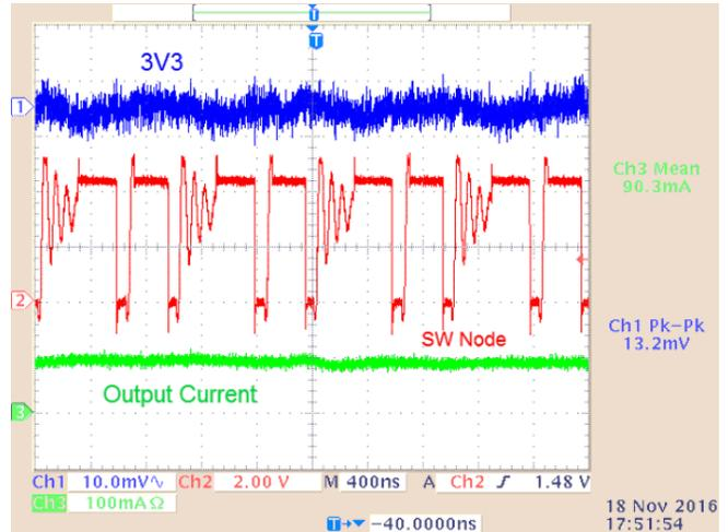
Figure 45. "3V3" Ripple (90-mA Load; 24- $V_{AC}$  Source)
