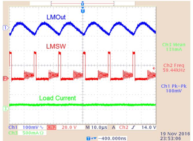
Figure 52. LMOut Ripple (130-mA Load)
