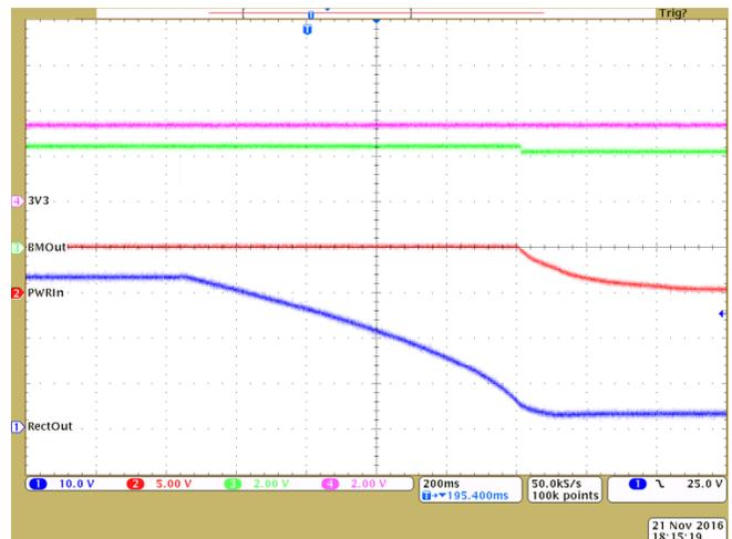
Figure 18. 24- $V_{AC}$  Shutdown
