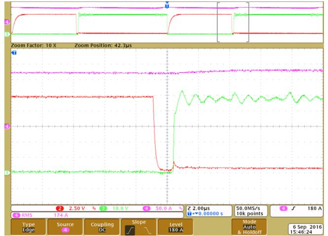
Figure 30. Bottom FET Soft Switch OFF
