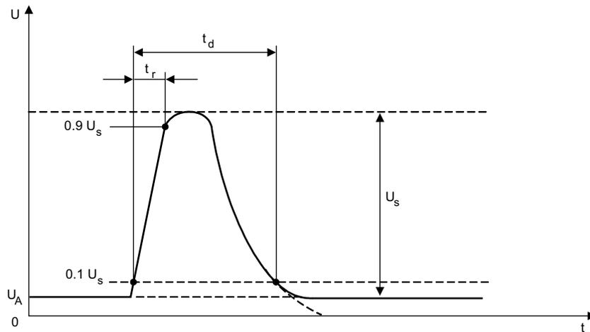
**Figure 8. Load-Dump Pulse**
