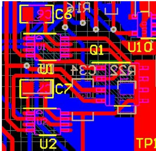
Figure 56. LM74610-Q1 Smart-Reverse Battery-Diode Layout
