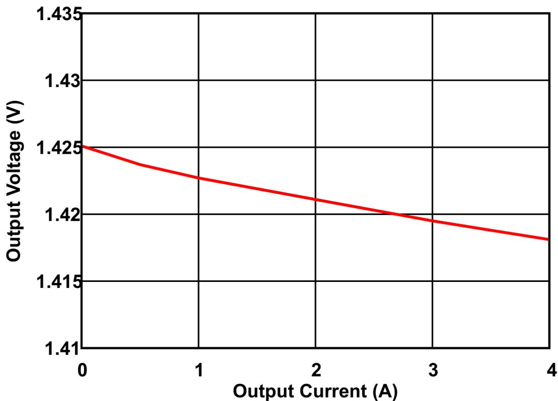
**Figure 24. TPS57114-Q1 Load Regulation**
