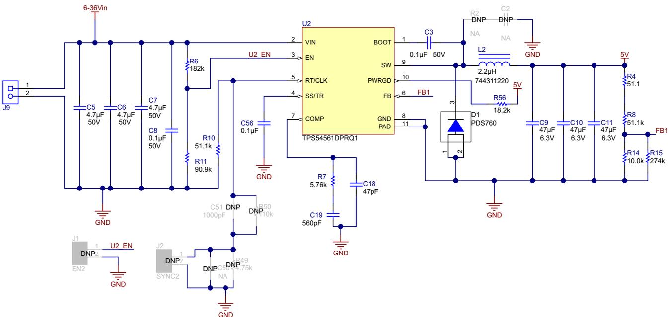
Figure 9. TPS54561-Q1 Circuit
