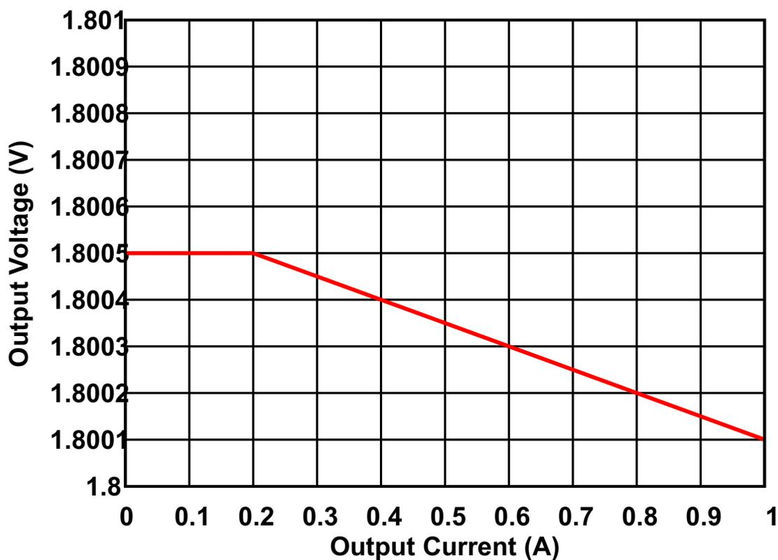
**Figure 29. LM26420-Q1 Load Regulation**
