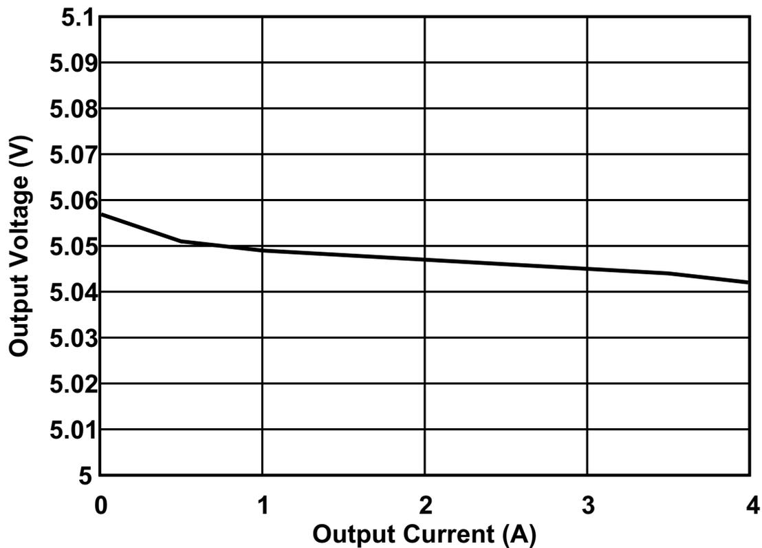
**Figure 14. TPS54561-Q1 Load Regulation**
