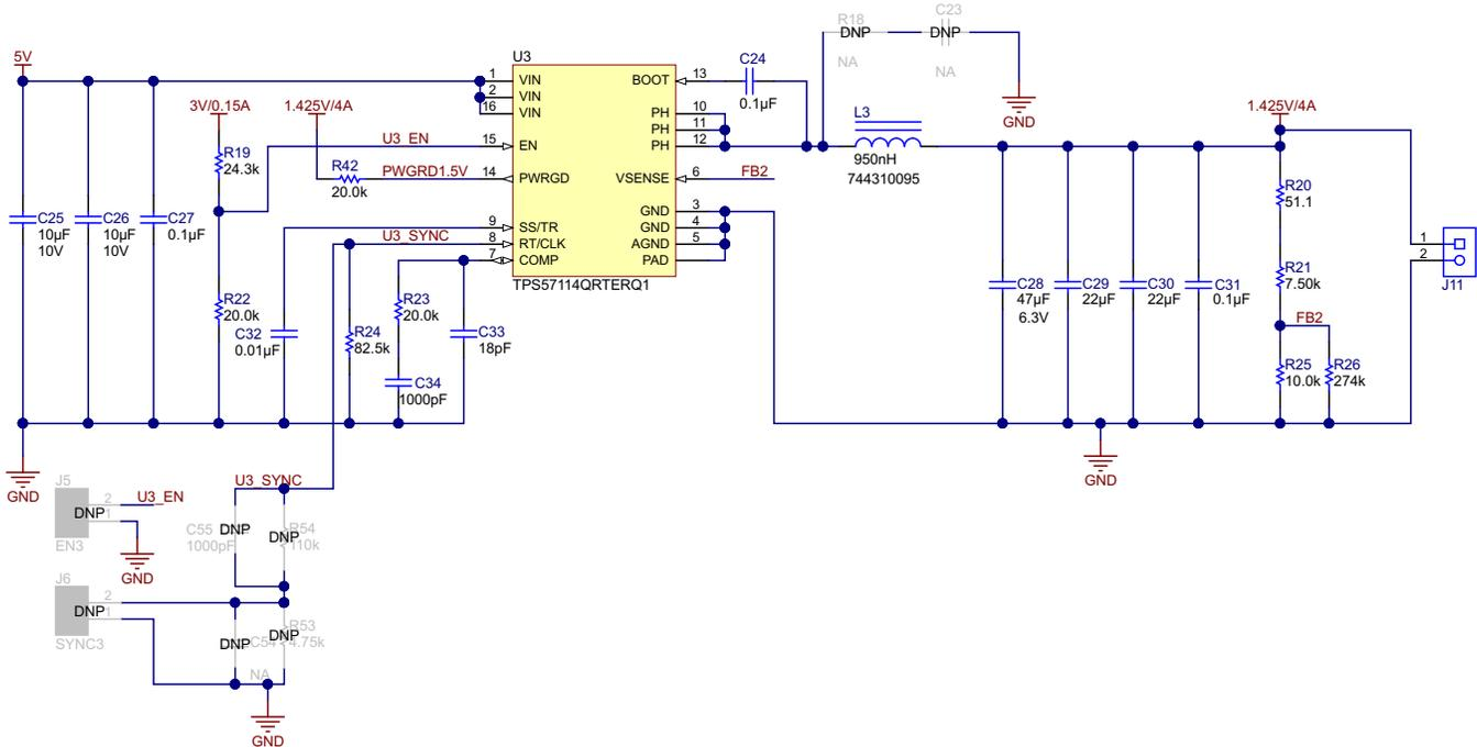
Figure 11. TPS57114-Q1 Circuit
