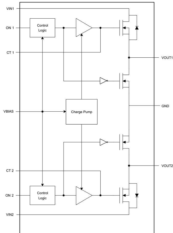
**Figure 10. TPS22966-Q1 Block Diagram**
