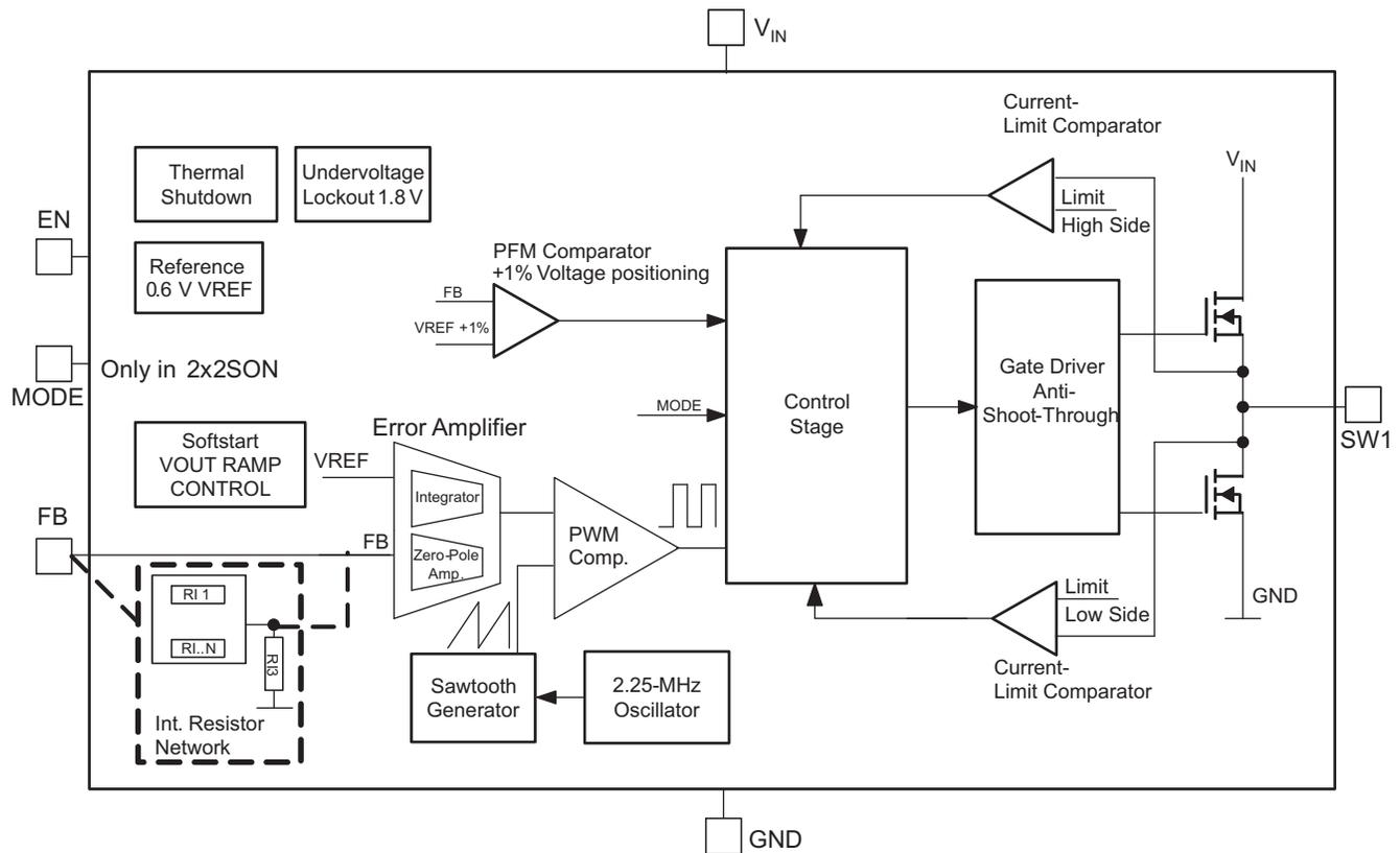
Figure 14. TPS62261-Q1 Block Diagram
