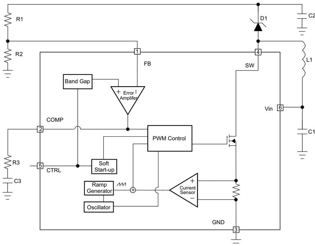
**Figure 13. TPS61170-Q1 Block Diagram**
