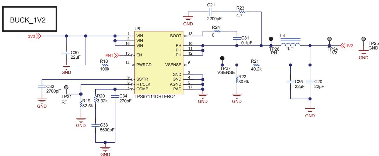
Figure 22. TPS57114-Q1 Buck Converter Schematic
