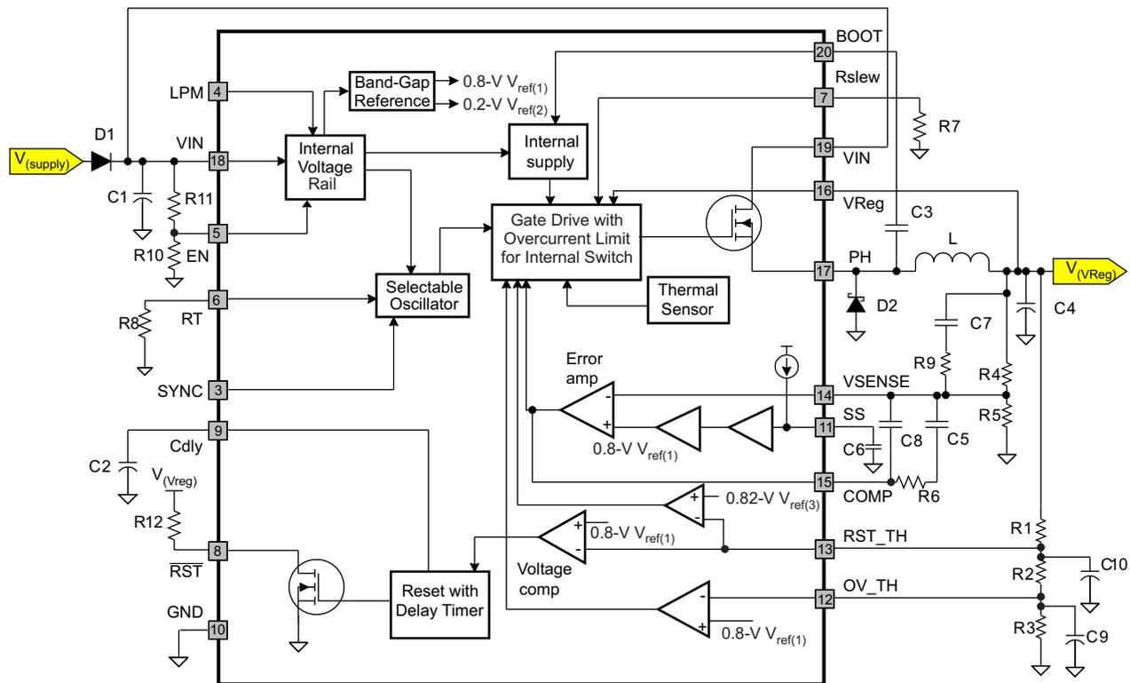
**Figure 11. TPS54362-Q1 Block Diagram**
