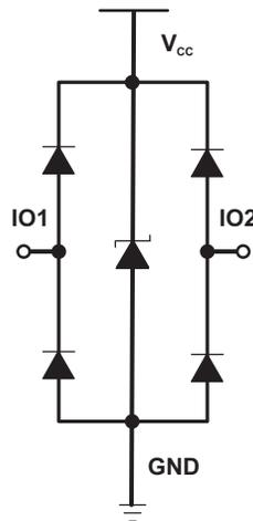
**Figure 9. TPD2E001 Block Diagram**
