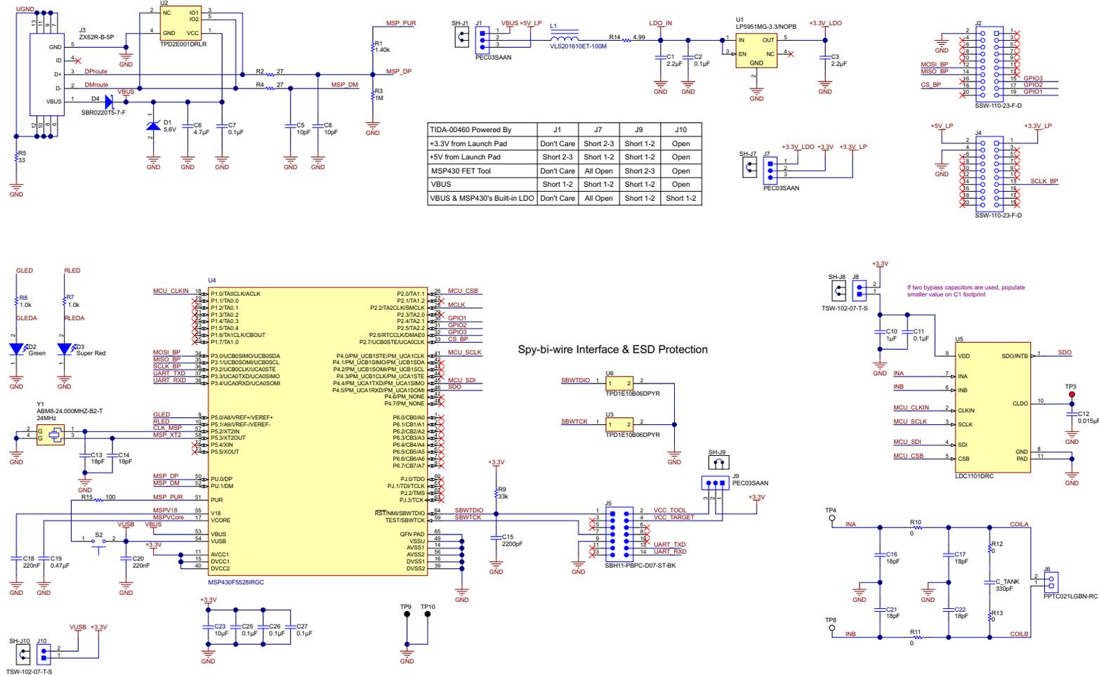
Figure 24. TIDA-00460 Schematic
