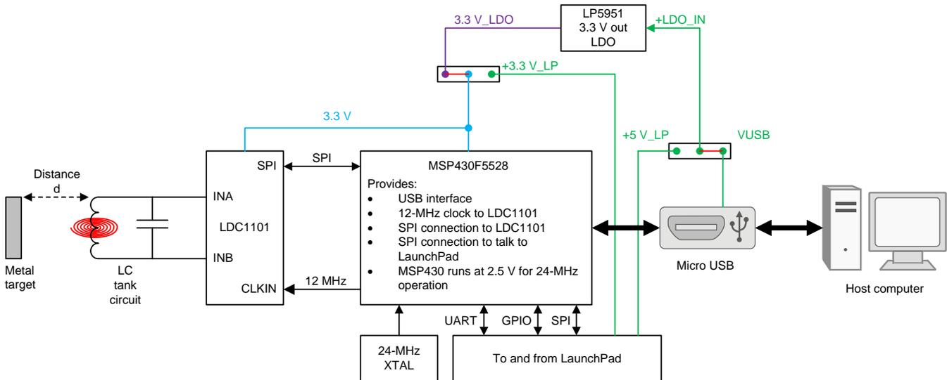
**Figure 4. TIDA-00460 Block Diagram**
