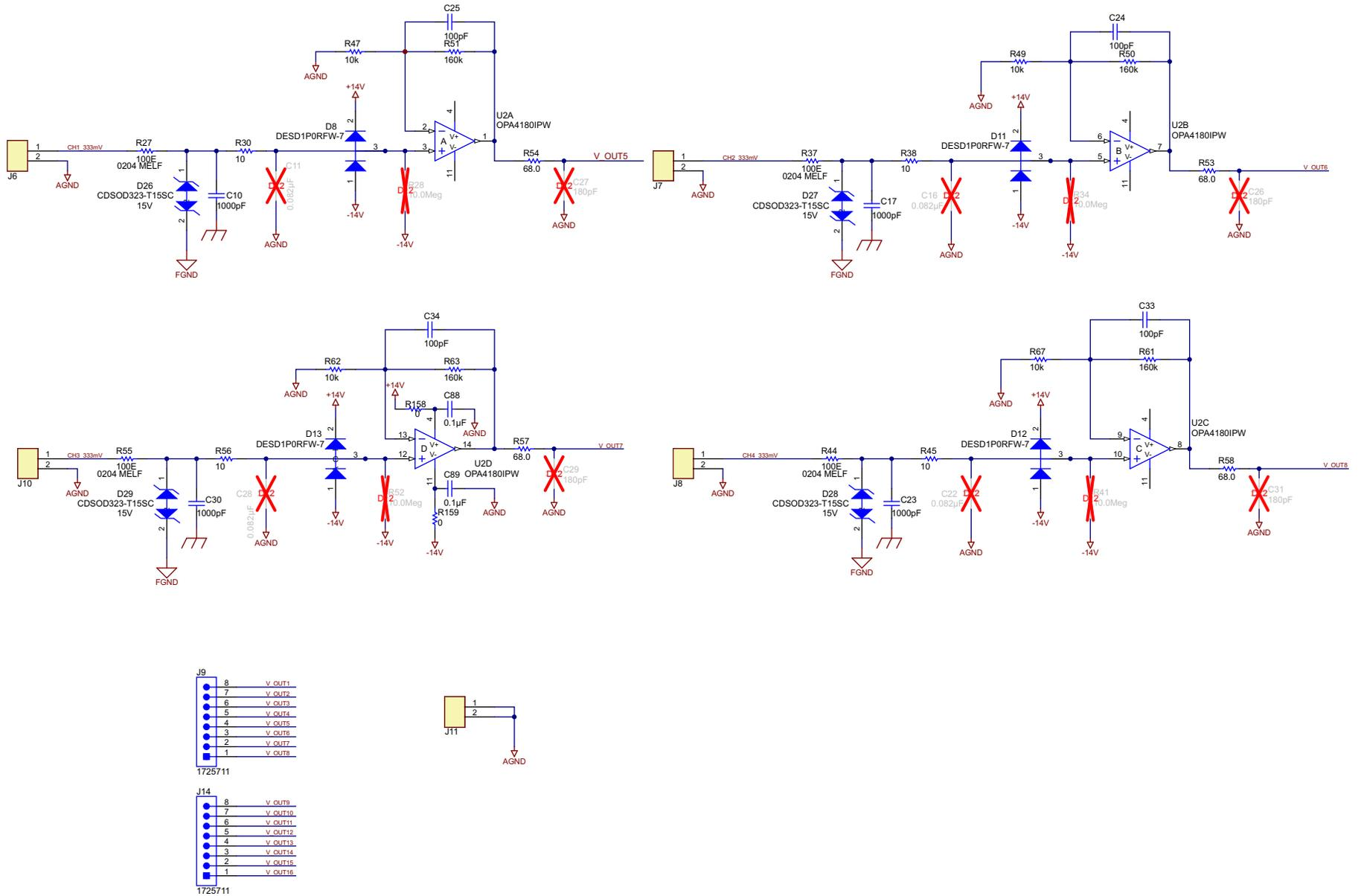
Figure 32. 333-mV Sensor Input
