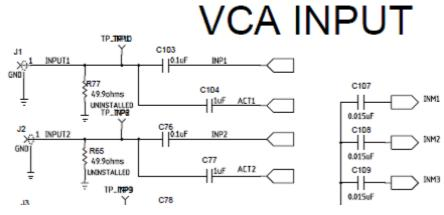
Figure 18. LNA Input AC Coupling Setup
