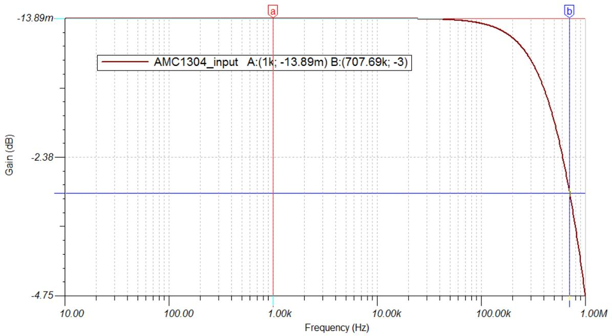
Figure 21. TINA-TI™ Simulation Result - AC Sweep
