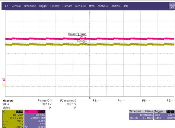
Figure 19. CH1: V<sub>BOOST</sub> CH2: Booster FET Drain 272-V AC
