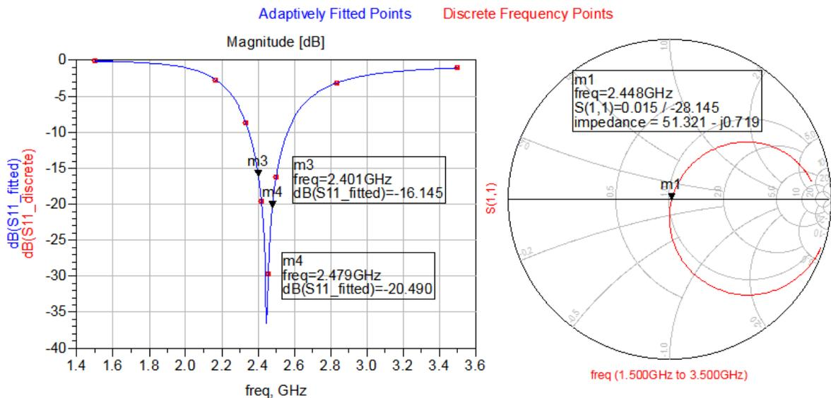
**Figure 3. Simulated S11. Substrate: 800 um FR4**
