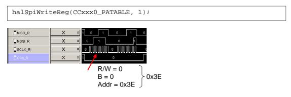
Figure 3. Single Byte Access
