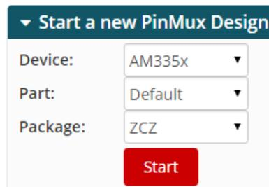
**Figure 2. PinMux Parameters**
