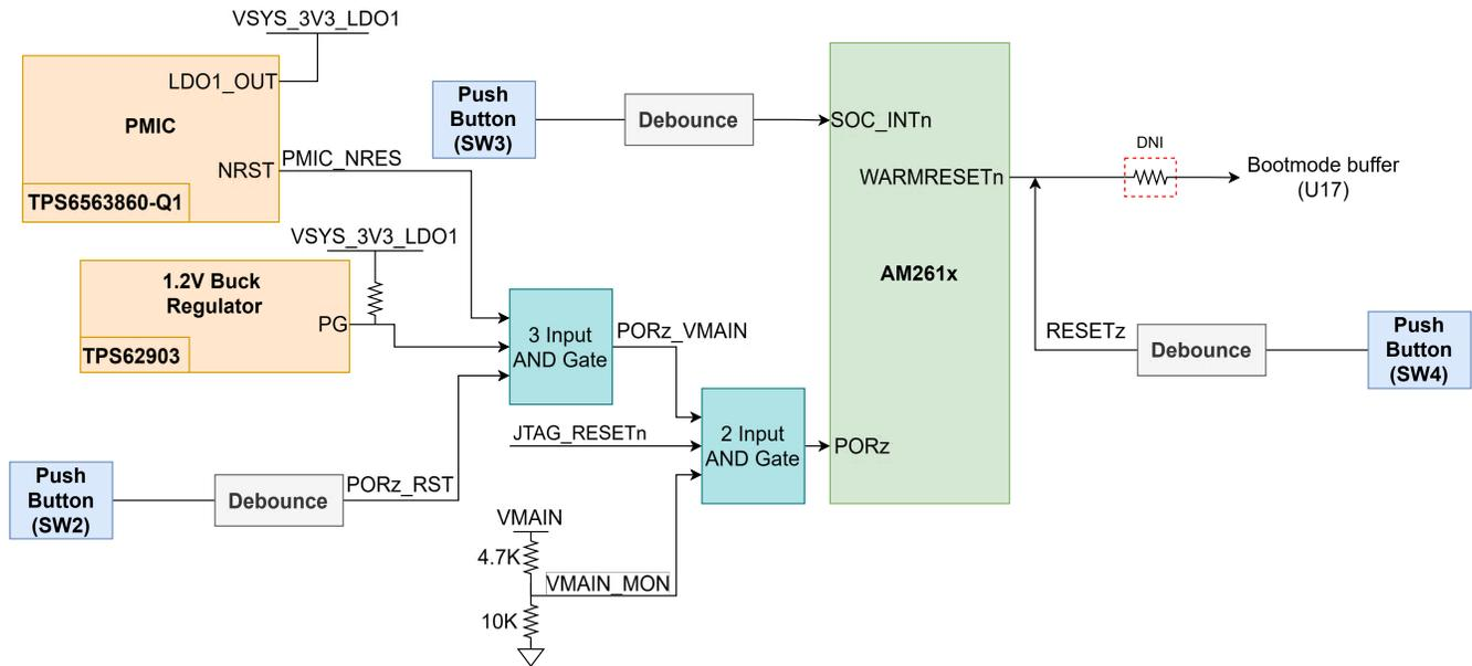
Figure 2-9. Reset Architecture
