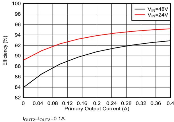
Figure 5-9. Efficiency :  $I_{OUT2}=I_{OUT3}=0.1 A$
