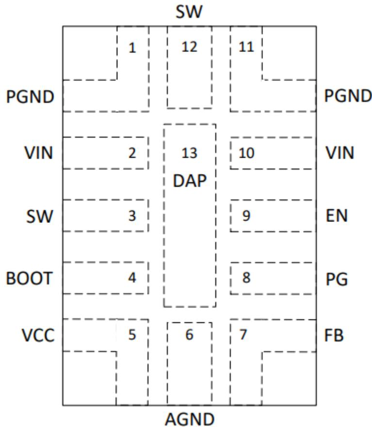
**Figure 4-1. Pin Diagram: LM60430, LM60440**
