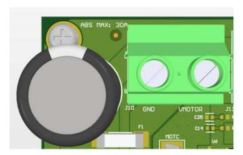
Figure 2-3. VMOTOR Input (J10)
