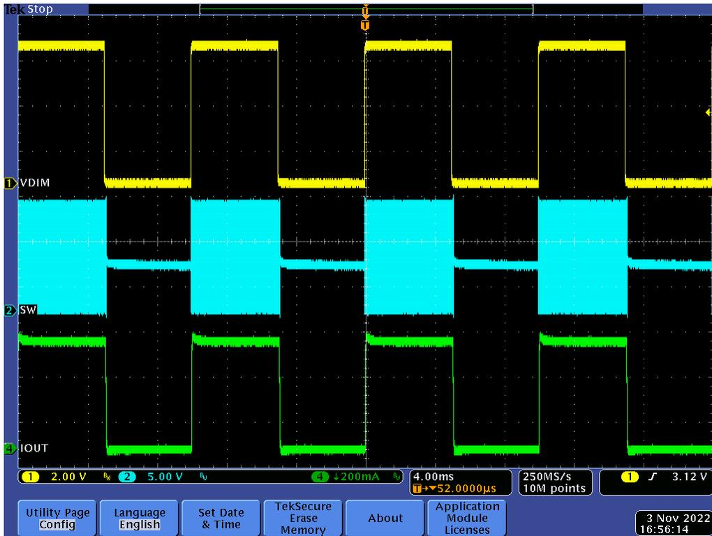
Figure 4-9. 50% Duty Cycle 100-Hz PWM Dimming(TPS92200D1RXLR)
