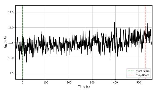
Figure 7-6. SEB On Run 15 (PWM Mode, f<sub>sw</sub> = 500kHz)
