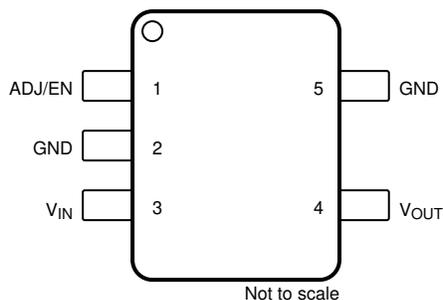
**Figure 4-1. Pin Diagram**
