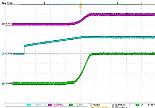
Figure 4-3. CV SEPIC Softstart Waveform, CH1SS3:0 = 7
