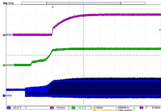
Figure 4-4. CC SEPIC Softstart Waveform, CH2SS3:0 = 15
