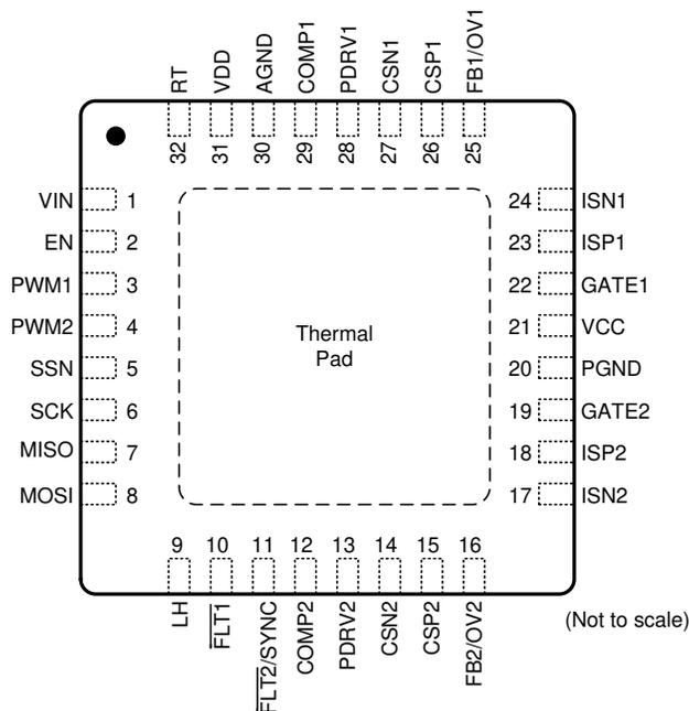
**Figure 3. Pin Diagram**
