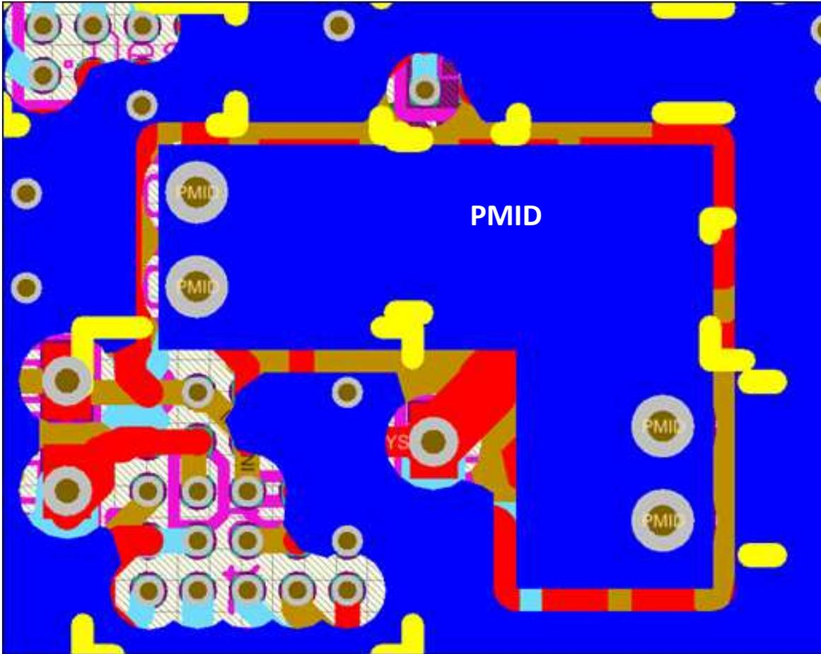
Figure 12. PMID Plane in Bottom Layer
