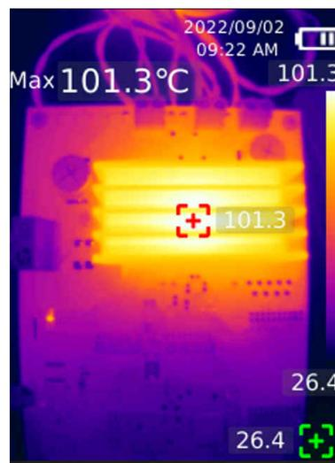
**Figure 2-7. DRV8462, DDV Package, Auto-Torque Disabled**
