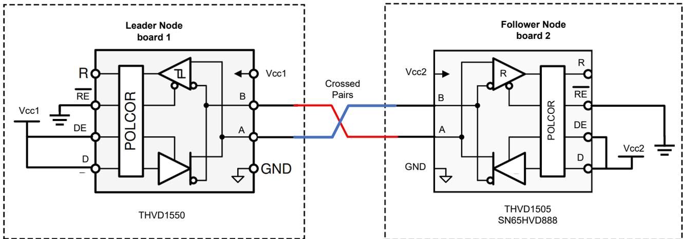
Figure 2-7. Test Case 3 Setup
